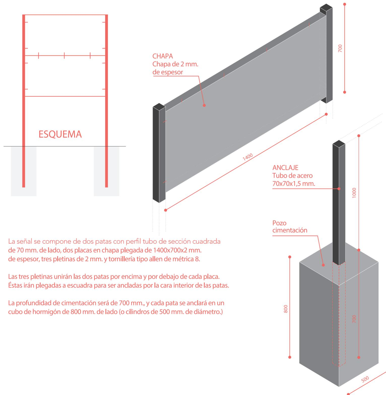
La señal se compone de dos patas con perfil tubo de sección cuadrada de 70 mm. de lado, dos placas en chapa plegada de 1400x700x2 mm. de espesor, tres pletinas de 2 mm. y tornillería tipo allen de métrica 8.
