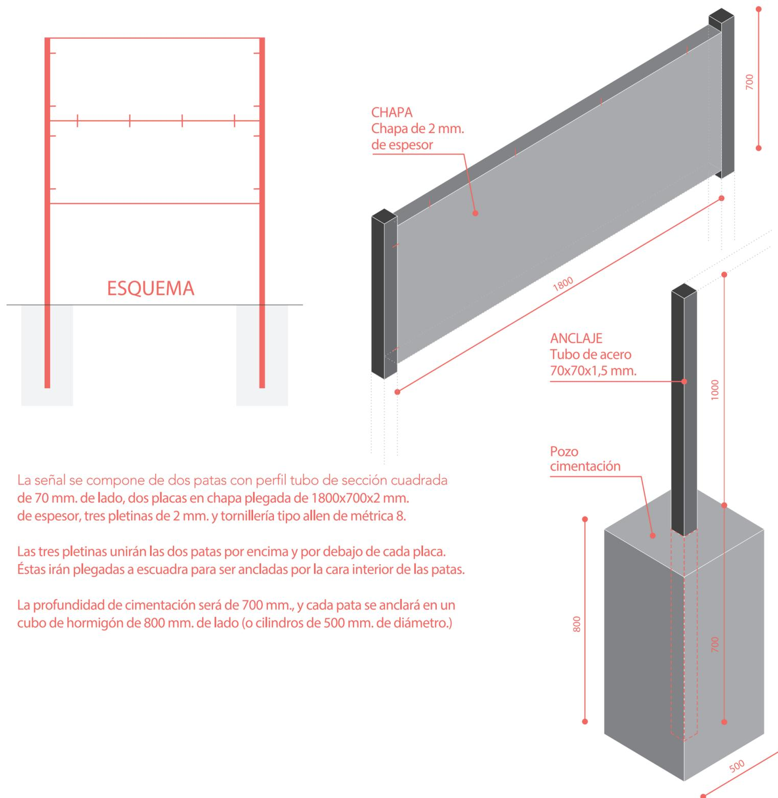
La señal se compone de dos patas con perfil tubo de sección cuadrada de 70 mm. de lado, dos placas en chapa plegada de 1800x700x2 mm. de espesor, tres pletinas de 2 mm. y tornillería tipo allen de métrica 8.
